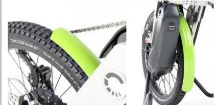
**Schutzblech, Kettenschutzscheibe und Motorabdeckung**
