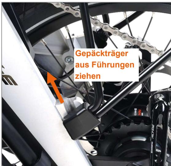
Abbildung 52: Gepäckträger aus den Führungen ziehen
