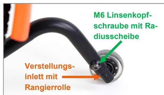
Abbildung 11: M6 Linsenkopfschraube mit Radius Scheibe und Verstellungsinlett zur Höheneinstellung des Abstellständers
