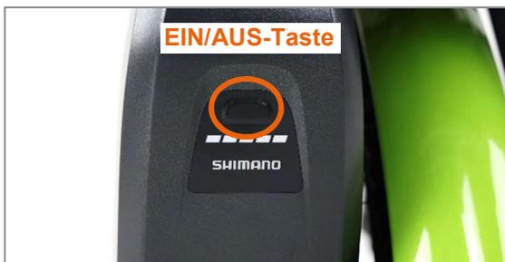
Abbildung 35: Ein- und Ausschalttaste am Shimano Akku
