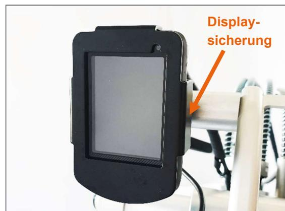
Abbildung 43: Display mit Displaysicherung
