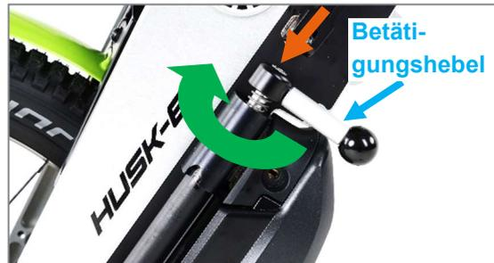
Abbildung 6: Nach unten drücken und drehen des Betätigungshebels
