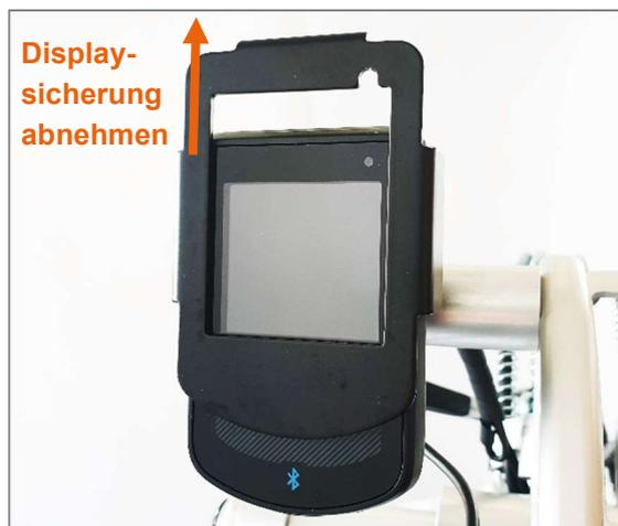
Abbildung 44: Abnahme Displaysicherung
