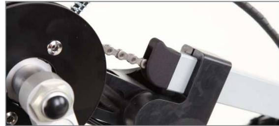
Abbildung 19: Kunststoff-Kettenführungen im Rechteckrohr
