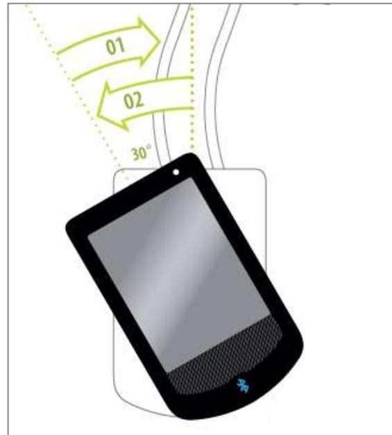
Abbildung 42: Anbringung und Abnahme des Displays
