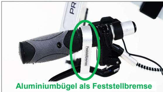
Abbildung 31: Aluminiumbügel als Feststellbremse
