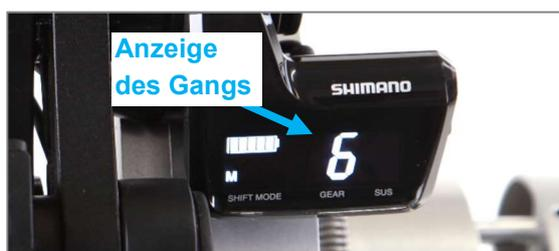
Abbildung 26: Anzeige des aktuellen Ganges im Display (neodrives)
