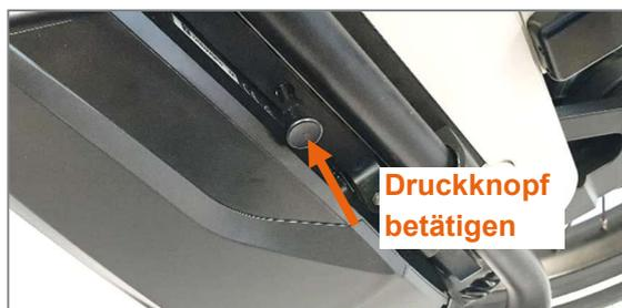
Abbildung 37: Druckknopf der schwenkbaren Akkuhalterung betätigen
