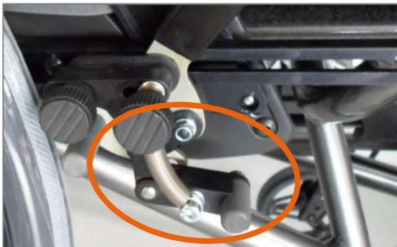
Abbildung 2: Rückrollsicherung
