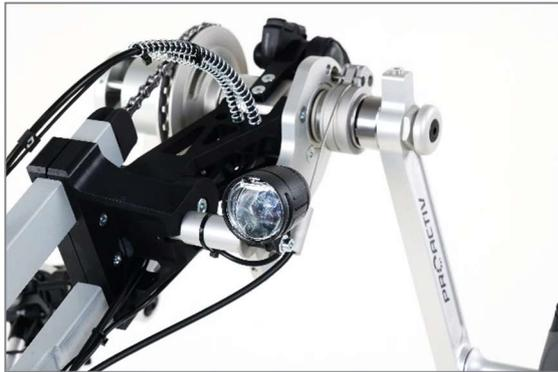
Abbildung 48: Frontbeleuchtung des LED Beleuchtungssets
