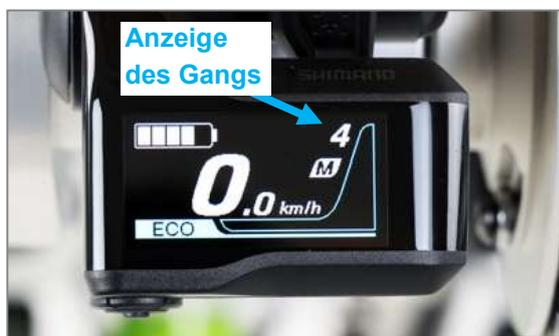
Abbildung 25: Anzeige des aktuellen Ganges im Display (Shimano)
