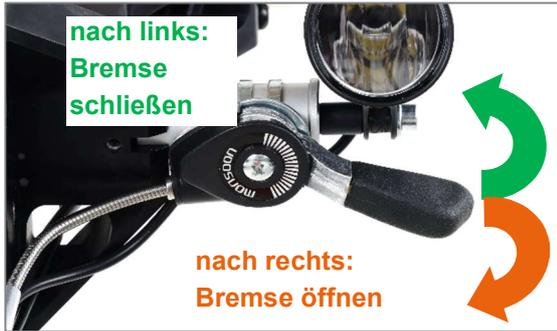
Abbildung 30: Feststellbremse über Rasthebel
