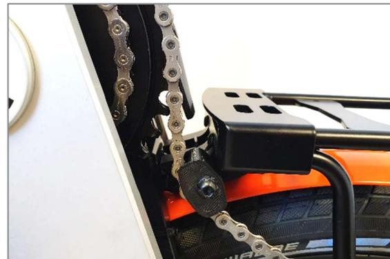
Abbildung 54: Gepäckträger angebracht, Kettenumlenkschuh spannt Kette
