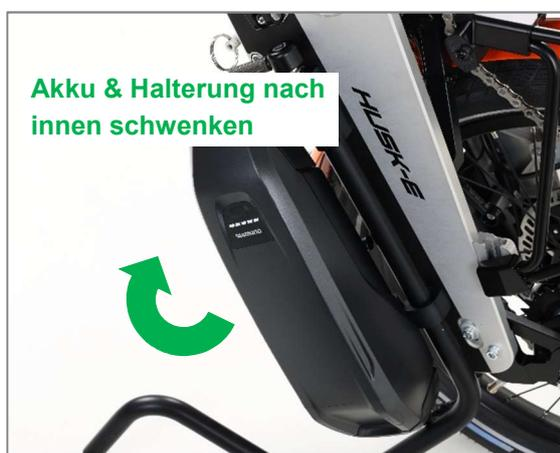
Abbildung 38: Zur Befestigung Akku & Halterung nach innen schwenken
