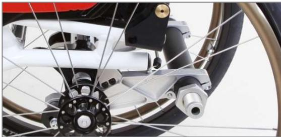
Abbildung 1: Abnehmbare Radstandsverlängerung
