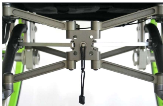
Abbildung 15: Position Auslöseschnur richtig, Bohrungen für Zentrierstifte frei
