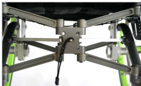
Abbildung 16: Position Auslöseschnur falsch, Bohrungen für Zentrierstifte unten links verdeckt
