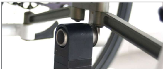
Abbildung 10: Zentrierzapfen mit aufgesteckter Zentrierzapfenaufnahme
