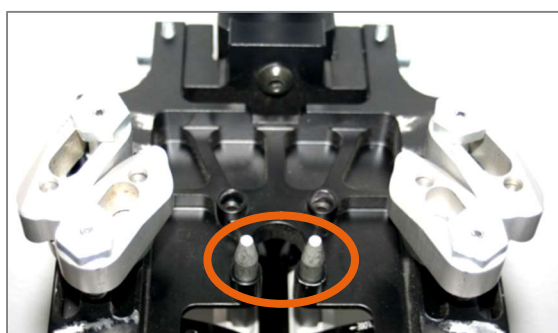
Abbildung 30: Zentrierstifte montiert für schmales Mittelteil
