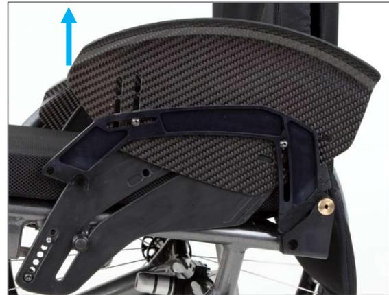
Abbildung 47: Kleiderschutz vorne aus der Seitenblechführung gezogen (Ansicht ohne Antriebsrad)
