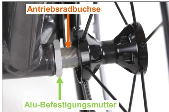
Abbildung 61: Antriegsradbuchse und Alu-Befestigungsmutter (Ansicht von hinten)
