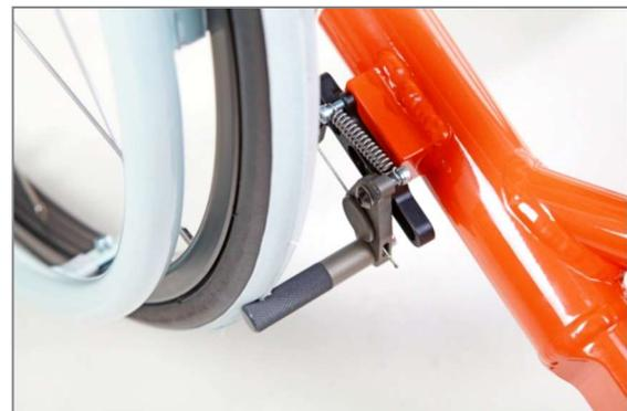
Abbildung 145: Kniehebelbremse mit Seilzugbedienung, Bremseinheit
