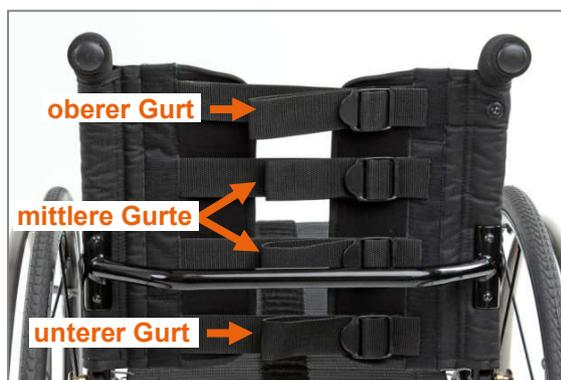
Abbildung 11: Gurtsystem der anpassbaren Rückenbespannung mit vier Gurten
