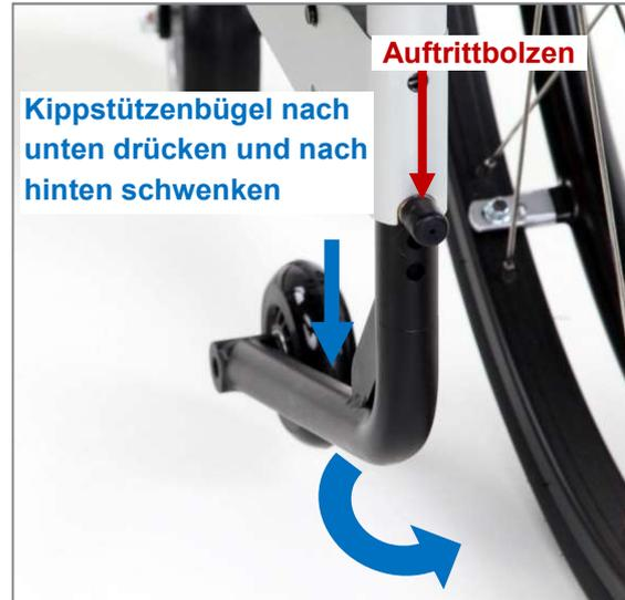
Abbildung 121: Kippstütze in Betriebsstellung bringen (Ansicht von hinten)
