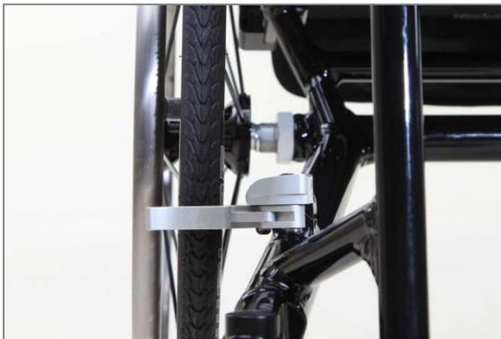
Abbildung 162: Anbringung der Integralbremse am unteren Rahmenrohr
