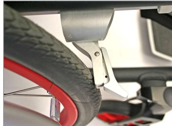
Abbildung 159: Bremselement an der Bereifung anliegend
