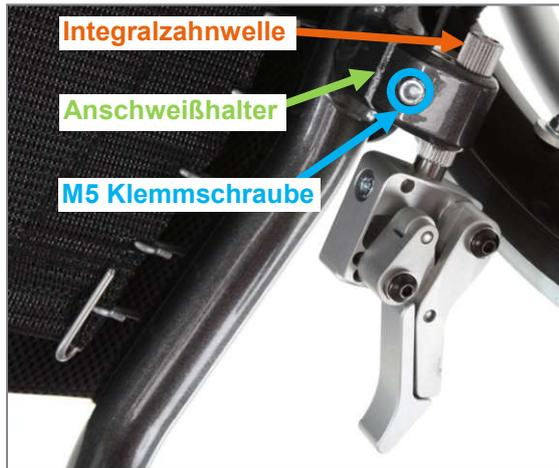
Abbildung 164: Bezeichnungsübersicht der Integralbremse (Produktansicht von unten)
