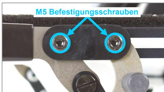
Abbildung 140: M5 Befestigungsschrauben an der Bremshalteschiene
