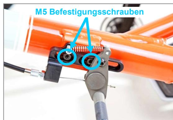
Abbildung 149: M5 Befestigungsschrauben
