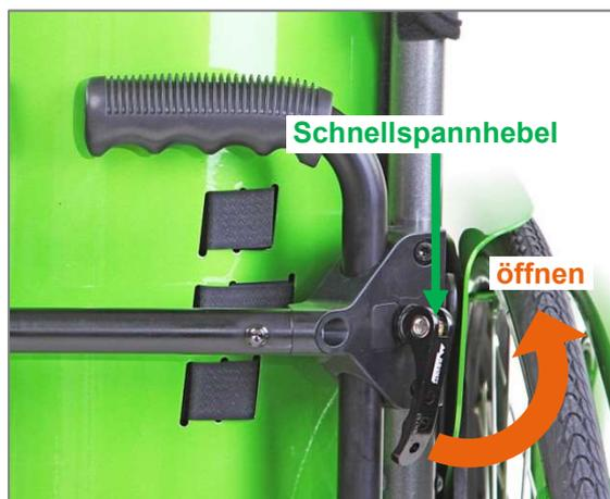
Abbildung 174: Geschlossener Schnellspannhebel
