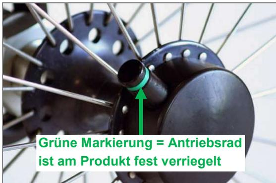
Abbildung 57: Tetra-Clip mit verriegelter Steckachse
