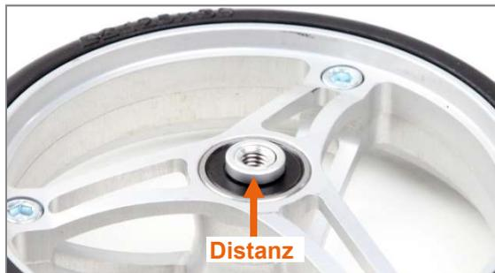
Abbildung 84: Distanz am Lenkrad
