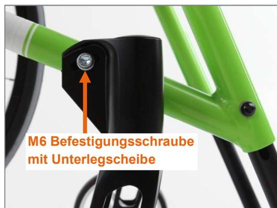
Abbildung 99: M6 Befestigungsschraube an der Rahmenaußenseite
