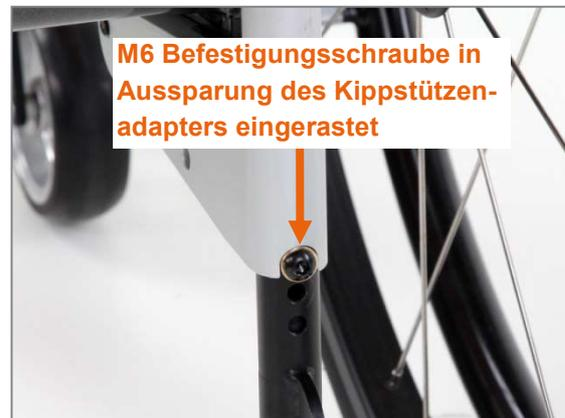
Abbildung 122: Kippstütze ordnungsgemäß eingerastet
