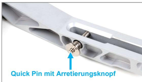
Abbildung 72: Quick Pin der Radstandsverlängerung mit Arretierungsknopf
