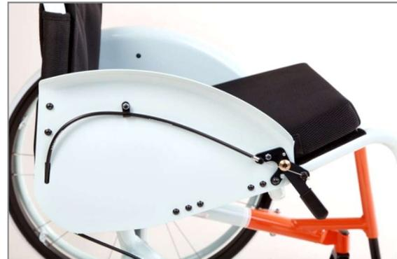
Abbildung 144: Kniehebelbremse mit Seilzugbedienung, Bedieneinheit
