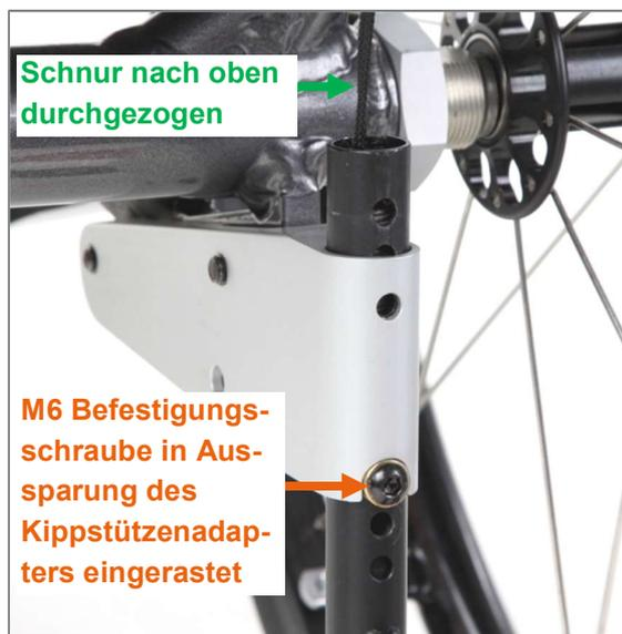
Abbildung 125: Kippstützenbügel in Kippstützenadapter eingesteckt
