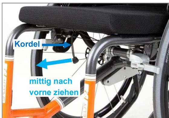
Abbildung 46: Kordel für die Betätigung der Rastbolzen
