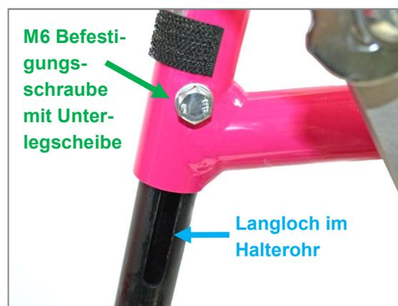
Abbildung 108: M6 Befestigungsschraube mit Unterlegscheibe und Langloch im Fußstützen-Halterohr zur Einstellung der Unterschenkellänge
