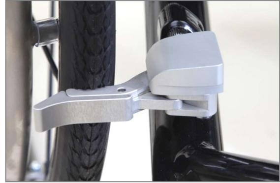
Abbildung 163: Anbringung der Integralbremse am unteren Rahmenrohr
