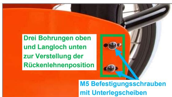
Abbildung 5: Verstellung der Rückenlehnenposition über Bohrungen im Seitenblech bzw. Kleiderschutz
