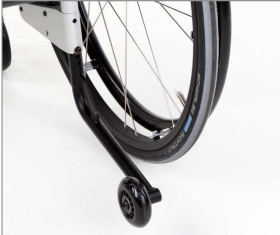
Abbildung 119: Betriebsstellung der Kippstütze (Ansicht von hinten)
