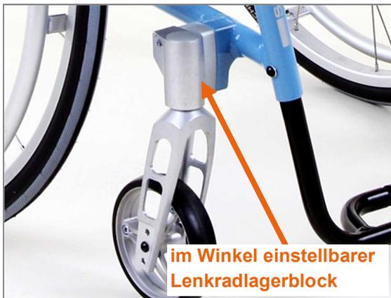
Abbildung 1: Im Winkel einstellbarer Lenkradlagerblock
