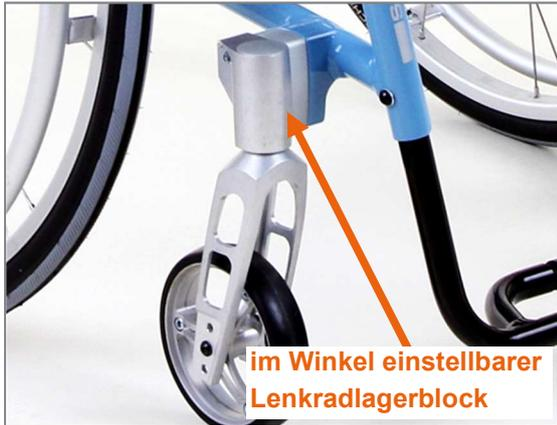
Abbildung 80: Im Winkel einstellbarer Lenkradlagerblock
