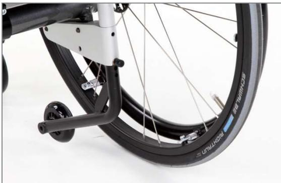
Abbildung 120: Passivstellung der Kippstütze (Ansicht von hinten)
