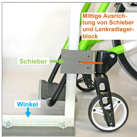
Abbildung 96: Überprüfung der Einstellung der Lenkradgabeldehachsen
