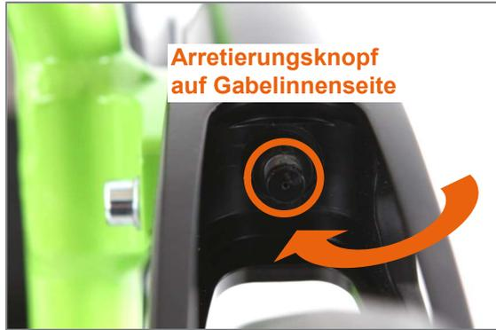
Abbildung 95: Lenkradgabel mit Steckachse und Arretierungsknopf
