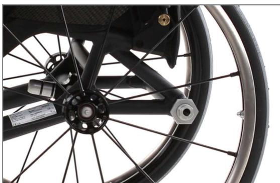
Abbildung 69: Radstandsverlängerung fest verschweißt (SPEEDY F2 oversized)
