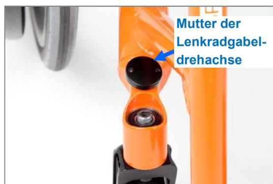
Abbildung 94: Mutter der Lenkradgabeldrehachse vollständig entfernt
