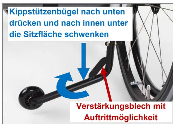
Abbildung 123: Kippstütze in Passivstellung bringen (Ansicht von hinten)
