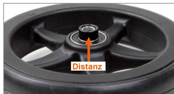
Abbildung 88: Distanz am Lenkrad
