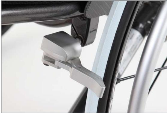
Abbildung 161: Anbringung der Integralbremse am oberen Rahmenrohr
