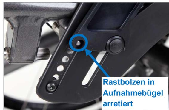
Abbildung 44: Rastbolzen in Aufnahmebügel des Kleiderschutzes arretiert (Ansicht mit Kleiderschutz)
