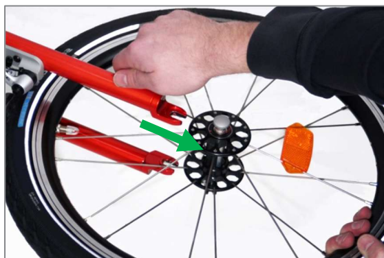
Abbildung 8: Rad nach unten herausziehen
