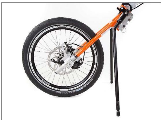
Abbildung 17: Abstellständer in Aktivposition
