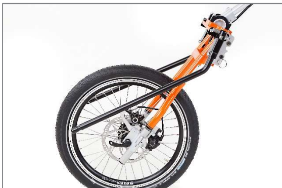
Abbildung 18: Abstellständer in Passivposition
