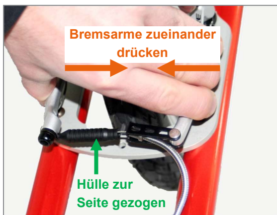
Abbildung 4: Hülle zur Seite gezogen und Bremsarme zueinander gedrückt
