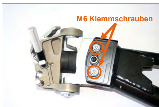
Abbildung 22: M6 Klemmschrauben am Lenkkopf
