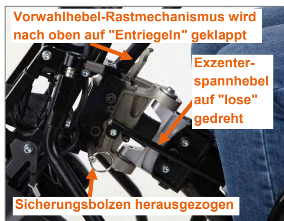
Abbildung 75: Vorbereitung für Abkopplung
