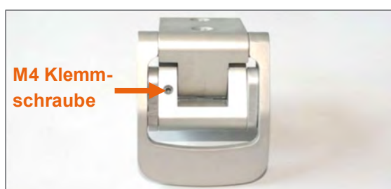
Abbildung 41: M4 Klemmschraube zum Einstellen der Betätigungskraft für Öffnen und Schließen der Spannklemmer (von vorne)
