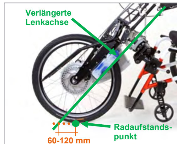
Abbildung 58: Nachlauf abhängig von der Winkeleinstellung des Lenkkopfes
