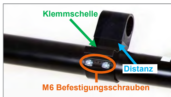
Abbildung 31: M6 Befestigungsschrauben zur horizontalen Positionierung der Zentrierzapfenaufnahme entlang des Adapterrohres
