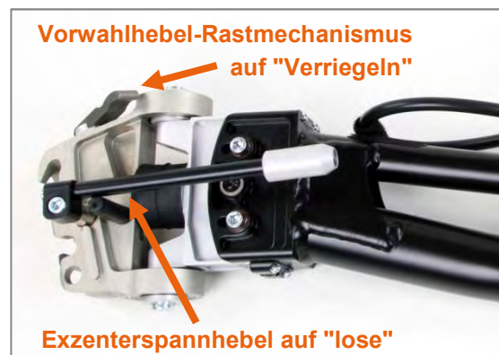
Abbildung 64: Adaptereinstellungen zu Beginn der Adaption
