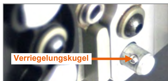
Abbildung 96: Sicherungsbolzen mit Verriegelungskugel, Verriegelungskugel auf der Außenseite der Andockplatte verriegelt
