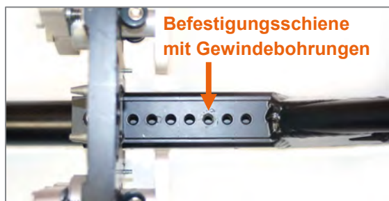
Abbildung 6: Positionierung der Verriegelungsplatte in 15 mm-Schritten
