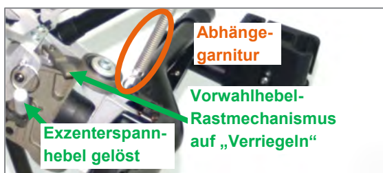
Abbildung 97: Einstellungen des Frontadapters zu Beginn der Adaption (Vorwahlhebel-Rastmechanismus und Exzenterstapenhebel)
