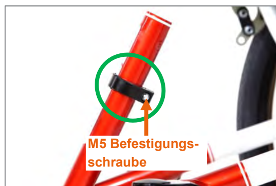
Abbildung 55: Fertig montierter Klemmhülsenanschlag (Rollstuhl seitlich)
