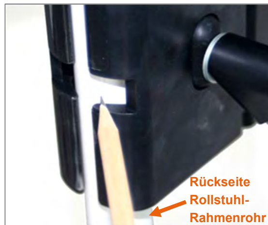
Abbildung 54: Anzeichnen der Position des Klemmhülsenanschlages an der Rahmenrohrrückseite des Rollstuhls
