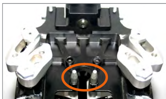
Abbildung 11: Zentrierstifte montiert für schmales Mittelteil
