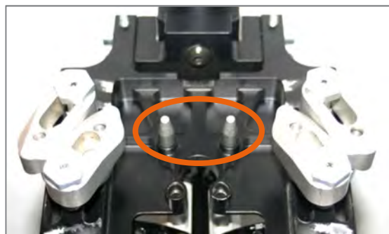
Abbildung 10: Zentrierstifte montiert für breites Mittelteil
