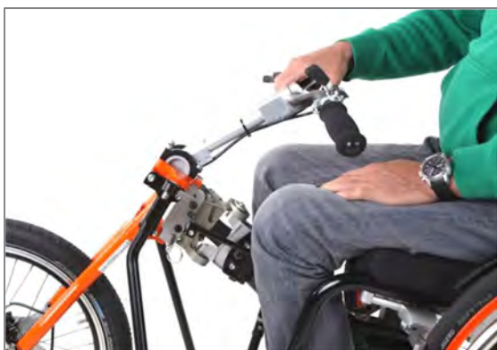
Abbildung 82: Eingehängter Einhängebolzen im Einhängemaule am Lenkkopf
