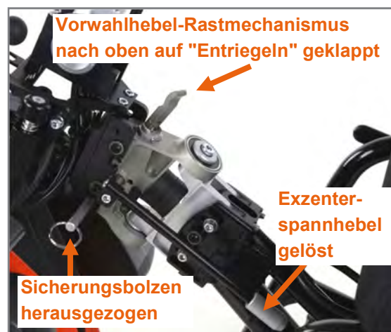
Abbildung 99: Vorbereitung für Abkopplung
