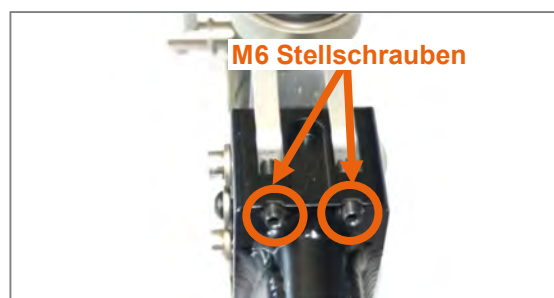
Abbildung 24: M6 Stellschrauben an der Lenkkopfanbindung anliegend
