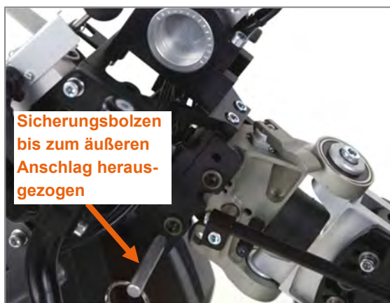
Abbildung 98: Einstellungen des Frontadapters zu Beginn der Adaption
