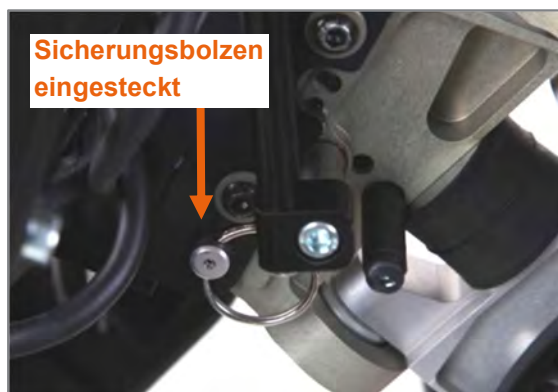
Abbildung 70: Adapter betriebsbereit adaptiert
