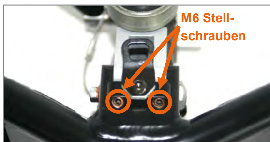
Abbildung 60: M6 Stellschrauben an der Lenkkopf anbindung anliegend
