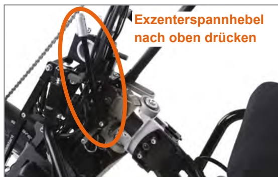
Abbildung 69: Exzentrerspannhebel wird auf "Spannen" gedrückt
