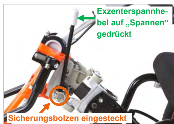
Abbildung 84: Adapter betriebsbereit adaptiert
