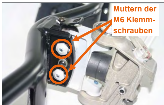
Abbildung 59: Mutter der M6 Klemmschrauben am Lenkkopf
