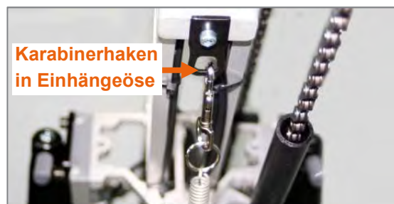
Abbildung 72: Abhängegarnitur bei Frontadapter, Karabinerhaken in Einhängeöse
