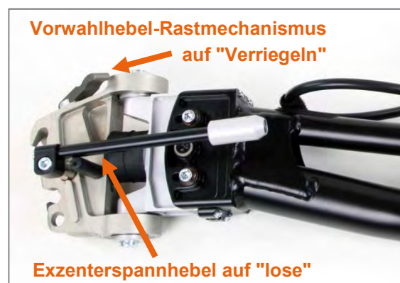
Abbildung 80: Adaptereinstellungen zu Beginn der Adaption
