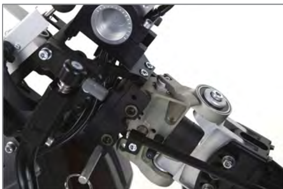
Abbildung 92: Eingehängter Einhängebolzen im Einhängemaul am Lenkkopf
