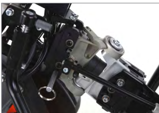
Abbildung 93: Adapterkopf vollständig an die Andockplatte angelegt
