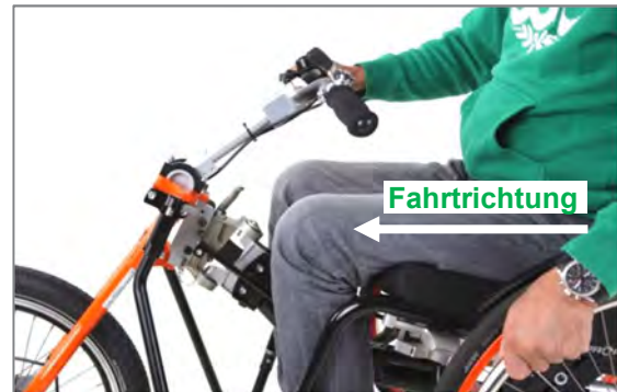
Abbildung 83: Bremse des Produkts drücken und mit den Greifringen in Richtung des Produkts fahren bis Arretierung erfolgt
