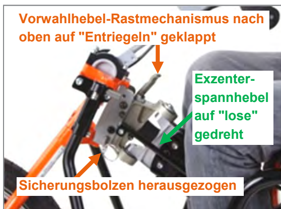
Abbildung 86: Vorbereitung für Abkopplung
