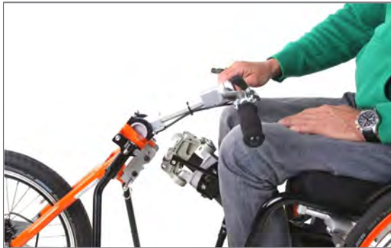
Abbildung 81: Einhängen des Einhängebolzens der Andockplatte im Einhängemaule am Lenkkopf
