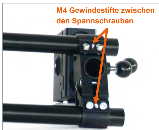
Abbildung 50: M4 Gewindestifte zum Öffnen der Klemmung für seitliches Verschieben der Klemme Lenkkopf-anbindung
