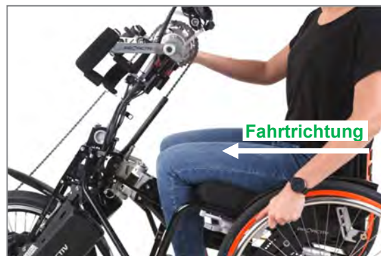
Abbildung 76: Fahren in Richtung des Produkts bis Entriegelung erfolgt
