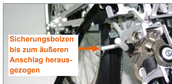
Abbildung 74: Einstellungen des Frontadapters zu Beginn der Adaption
