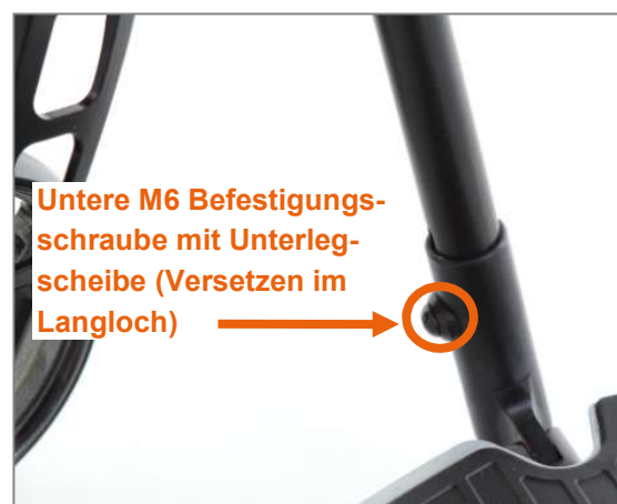
Abbildung 103: Untere M6 Befestigungsschraube kann im Langloch positioniert werden
