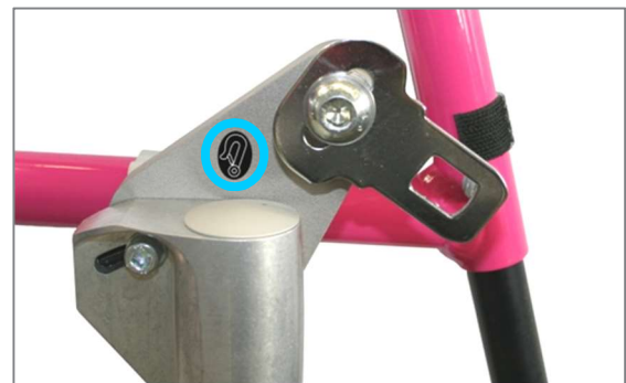
Abbildung 159: Lenkradlagerblockzwischenplatte mit Schlosszunge für Retraktor vorne
