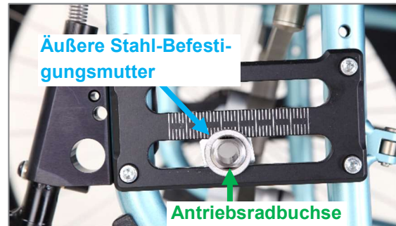
Abbildung 21: Äußere Stahl-Befestigungsmutter und Antriebsradbuchse (Ansicht von Produktaußenseite, Antriebsrad abgenommen)
