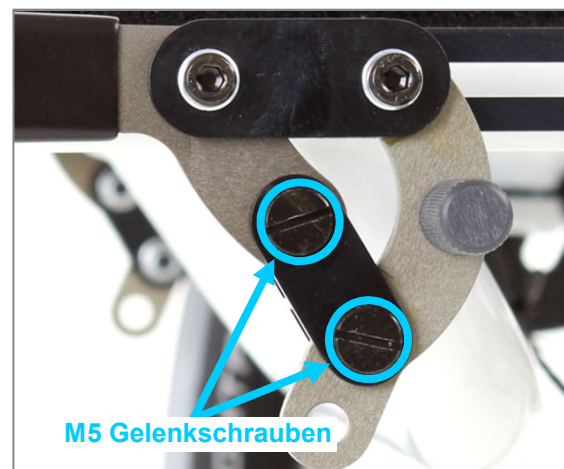
Abbildung 139: M5 Gelenkschrauben zur Einstellung der Betätigungskraft des Bremshebels
