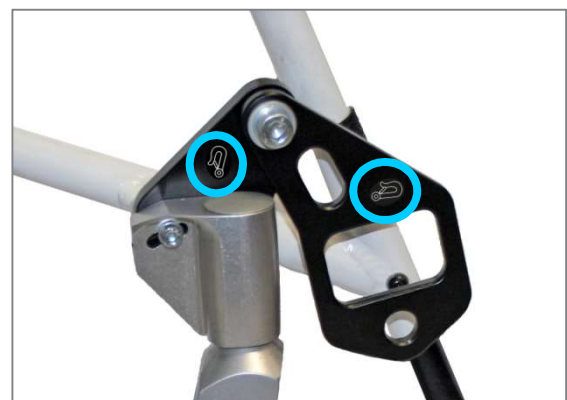
Abbildung 160: Lenkradlagerblockzwischenplatte mit Gurtöse für Retraktor vorne
