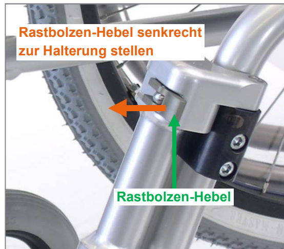
Abbildung 120: Rastbolzen-Hebel zur Abnahme der Swing away Fußstütze senkrecht stellen
