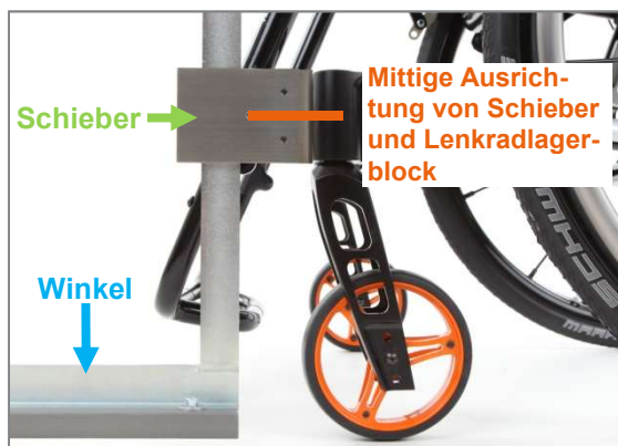
Abbildung 93: Überprüfung der Einstellung der Lenkradgabeldehachsen
