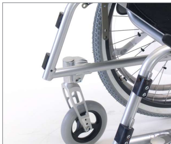
Abbildung 121: Swing away Fußstütze abgenommen
