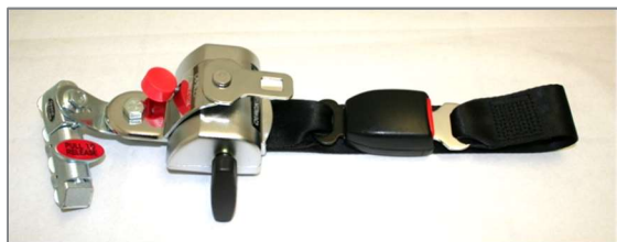
Abbildung 152: Retraktor hinten „Semi-Automatik“ mit Handrad, Gurtschloss und Schlosszunge
