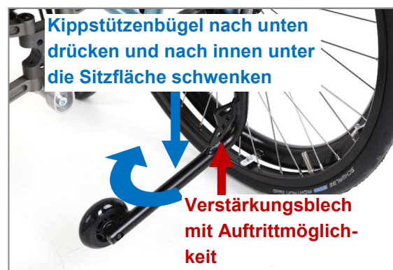
Abbildung 128: Kippstütze in Passivstellung bringen (Ansicht von hinten)
