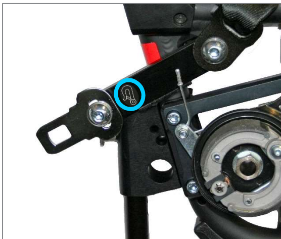
Abbildung 157: Kraftknotenverbindung am hinteren Rahmen mit Schlosszunge für Retraktor hinten und Beckengurt
