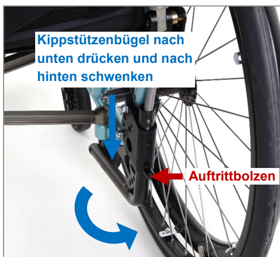
Abbildung 126: Kippstütze in Betriebsstellung bringen (Ansicht von hinten)
