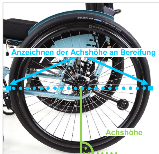
Abbildung 72: Anzeichnen der Achshöhe vorne und hinten auf beiden Reifen
