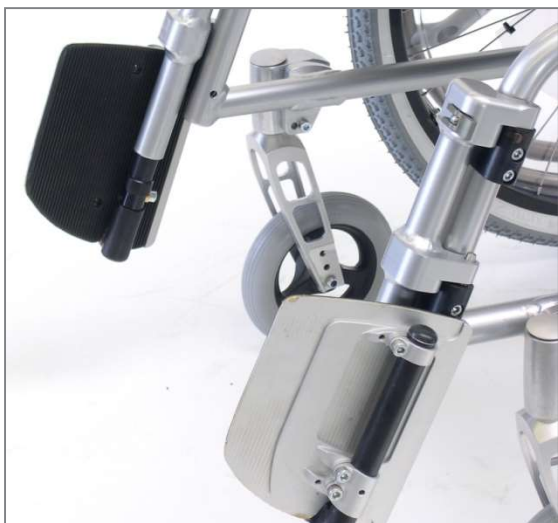
Abbildung 119: Beide Fußstützenteile hochgeklappt und nach außen gedreht
