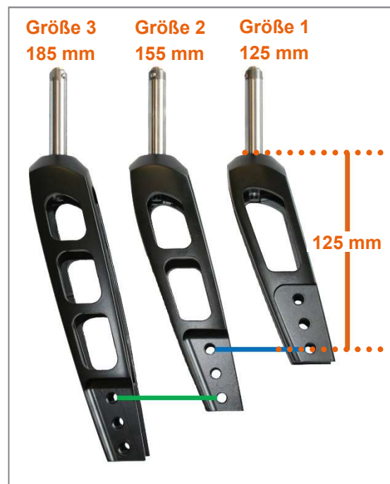
Abbildung 19: Lenkradgabelgrößen mit Kennzeichnung der gleichen Sitzhöhereinstellungen bei verschiedenen Lenkradgabelgrößen
