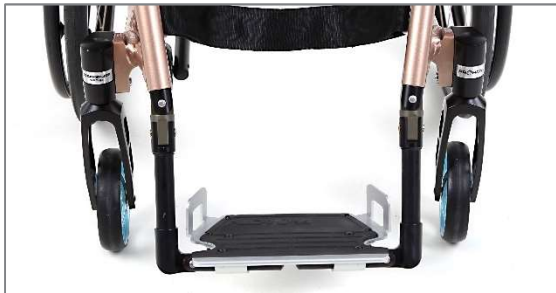
Abbildung 111: Fußstütze nach hinten hochfaltbar mit Federrastmechanismus, in Standardposition
