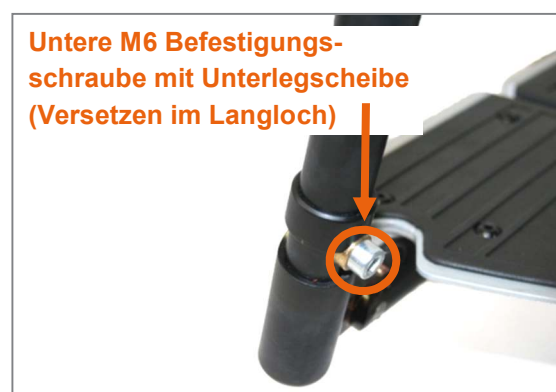
Abbildung 117: Untere M6 Befestigungsschraube (SW 5 mm) kann im Langloch positioniert werden
