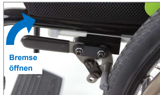
Abbildung 136: Bremse geschlossen; Öffnen erfolgt durch nach hinten-oben Ziehen des Bremshebels
