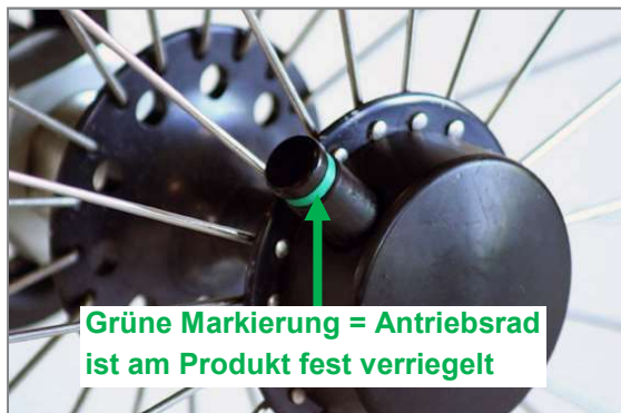
Abbildung 69: Tetra-Clip mit verriegelter Steckachse
