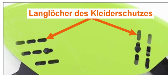
Abbildung 63: Langlöcher des Kleiderschutzes
