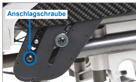
Abbildung 28: Anschlagschraube (Ansicht von Produktaußenseite)
