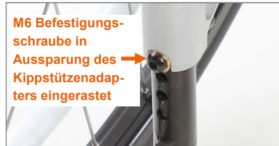
Abbildung 127: Kippstütze ordnungsgemäß eingerastet
