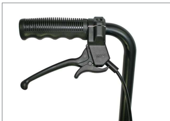
Abbildung 142: Bremsgriff an der Schiebevorrichtung mit Rasthebel
