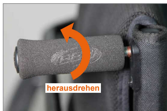
Abbildung 146: Schiebegriff horizontal aus dem Rückenrohr herausdrehen
