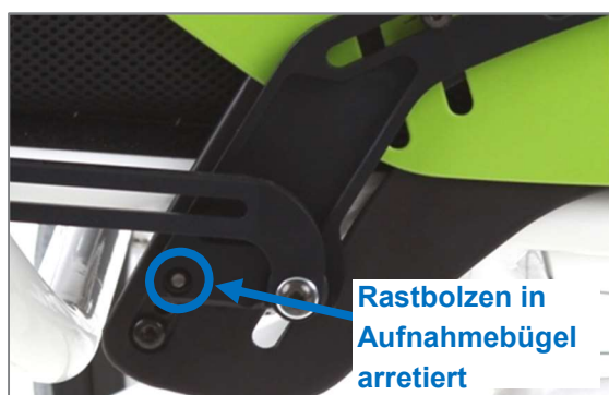
Abbildung 56: Rastbolzen in Aufnahmebügel des Kleiderschutzes arretiert (Ansicht mit Kleiderschutz)
