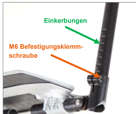
Abbildung 113: Einkerbungen und M6 Befestigungsklemmschraube zur Unterschenkelängen-Einstellung (Ansicht von hinten)
