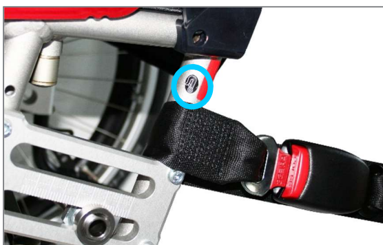
Abbildung 162: Symbol für hintere Befestigung und Umschlaufung des Rollstuhls hinten
