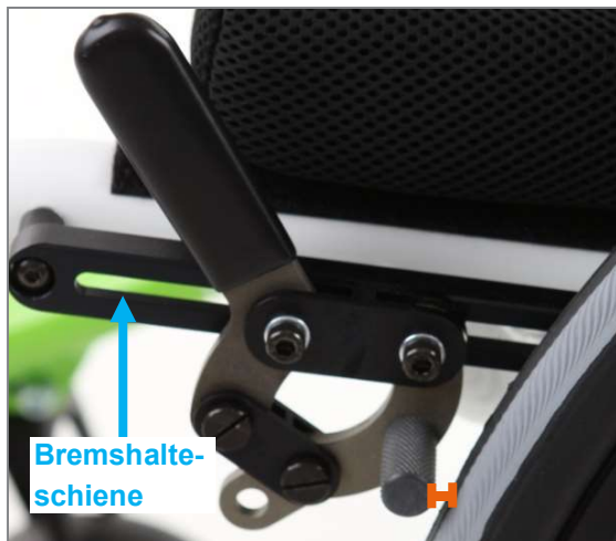
Abbildung 138: Abstand zwischen Bremsbolzen und Bereifung von ca. 3 bis maximal 4 mm bei geöffneter Bremse
