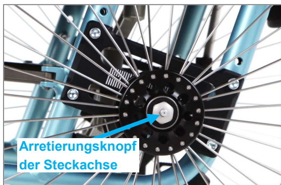
Abbildung 66: Arretierungsknopf der Steckachse in der Mitte der Radachse
