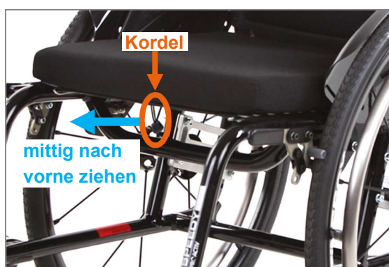
Abbildung 58: Kordel für die Betätigung der Rastbolzen
