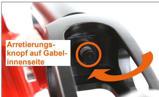
Abbildung 92: Lenkradgabel mit Steckachse und Arretierungsknopf
