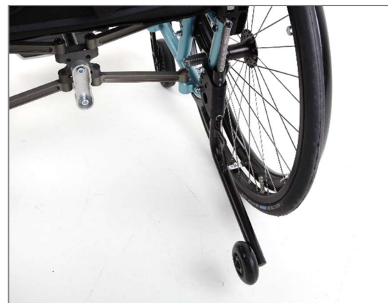
Abbildung 124: Betriebsstellung der Kippstütze (Ansicht von hinten)
