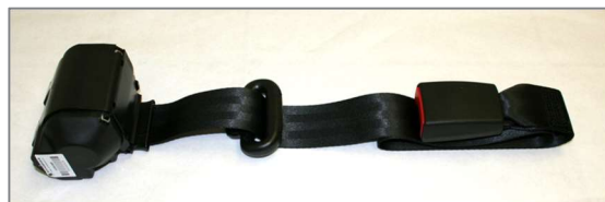
Abbildung 154: Schulterschräggurt automatisch mit Umlenkung und Gurtschloss
