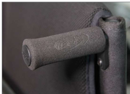
Abbildung 145: Schiebegriffe horizontal im Rückenrohr eingeschraubt
