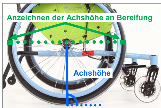
Abbildung 27: Anzeichnen der Achshöhe vorne und hinten auf beiden Reifen
