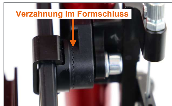
Abbildung 16: Verzahnung am Fußbügelspanner, im Formschluss
