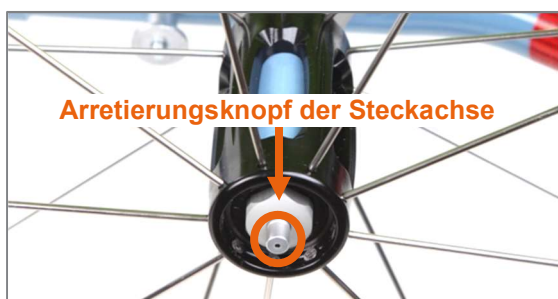
Abbildung 24: Arretierungsknopf der Steckachse in der Mitte der Radachse
