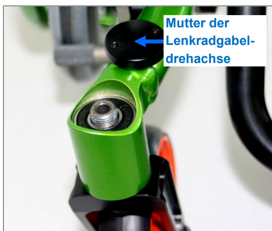
Abbildung 47: Mutter der Lenkradgabel-drehachse vollständig entfernt
