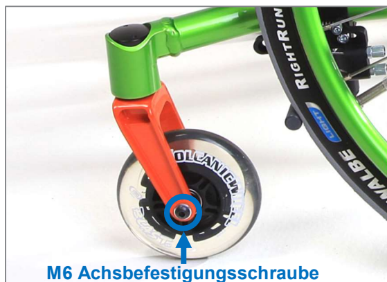
Abbildung 37: M6 Achsbefestigungsschraube der Lenkradachse (Ansicht von Produktaußenseite)
