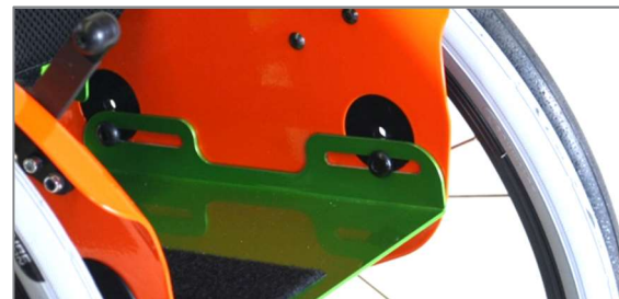
Abbildung 3: Sitzplatte in tiefer Position, Langlöcher oben
