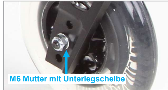
Abbildung 42: M6 Mutter der Lenkradachse (Ansicht von Produktinnenseite)
