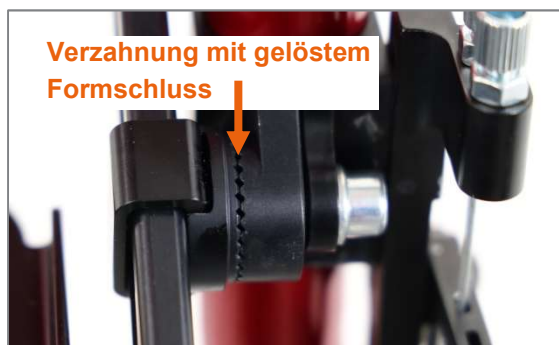
Abbildung 18: Verzahnung am Fußbügelspanner, gelöster Formschluss
