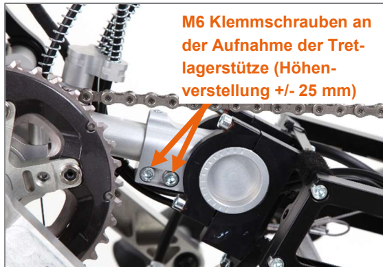
Abbildung 8: M6 Klemmschrauben für die Höhenverstellung der Tretlagerposition
