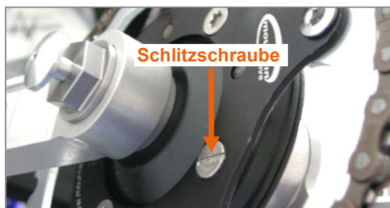
Abbildung 20: Schlitzschraube zum Fetten
