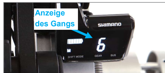
Abbildung 13: Anzeige des aktuellen Gangs im Display
