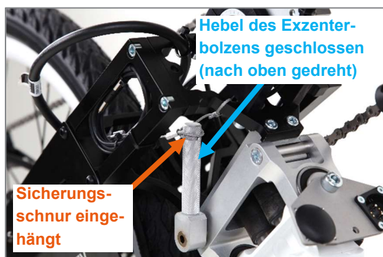
Abbildung 65: Antriebseinheit vollständig adaptiert
