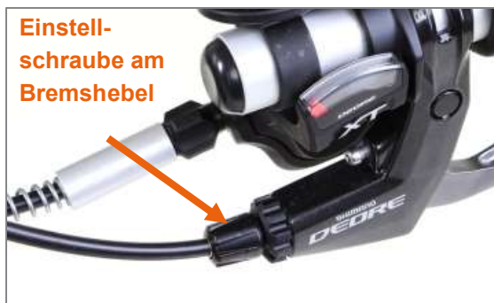
Abbildung 23: Einstellschraube am Bremshebel
