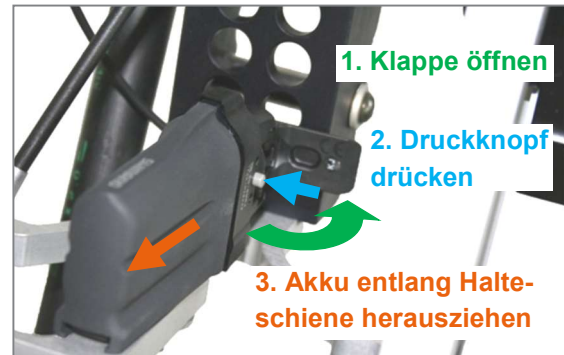
Abbildung 16: Akku zum Laden entnehmen
