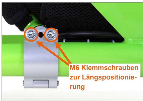
Abbildung 38: Längsverstellung der Rückenlehne über M6 Klemmschrauben und Klemmschellen am Produktrahmen
