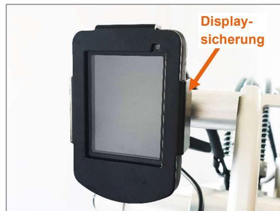
Abbildung 30: Display mit Displaysicherung
