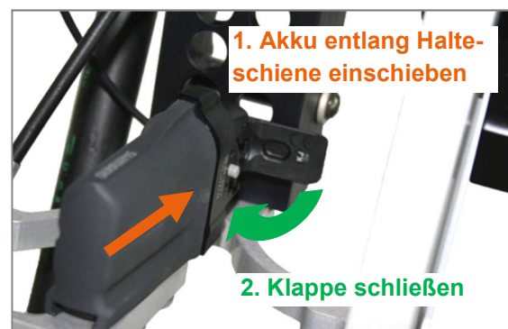
Abbildung 18: Akku nach dem Laden wieder anschließen
