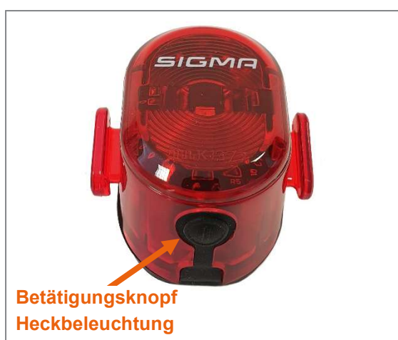
Abbildung 33: Betätigungsknopf der Heckbeleuchtung
