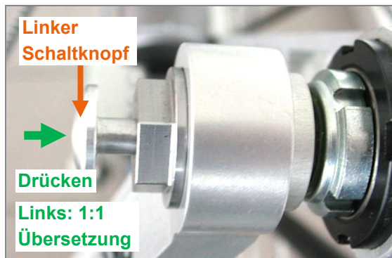
Abbildung 19: Linker Schaltknopf der Tretlagerschaltung
