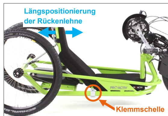
Abbildung 37: Klemmschelle für Längspositionierung der Rückenlehne
