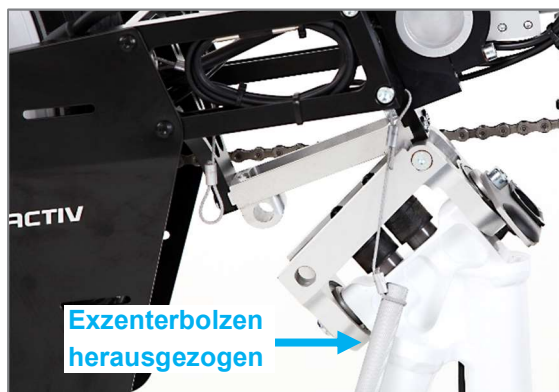
Abbildung 69: Exzenterbolzen aus den Adapterplatten herausgezogen, Chassis auf Boden abgelassen
