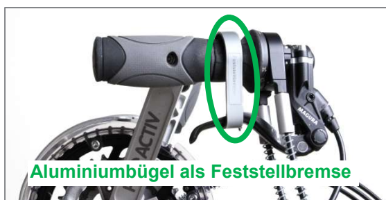
Abbildung 24: Aluminiumbügel als Feststellbremse
