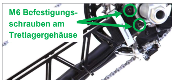
Abbildung 6: M6 Befestigungsschrauben am Tretlagergehäuse
