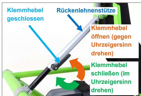
Abbildung 35: Winkelverstellung der Rückenlehne über Klemmhebel
