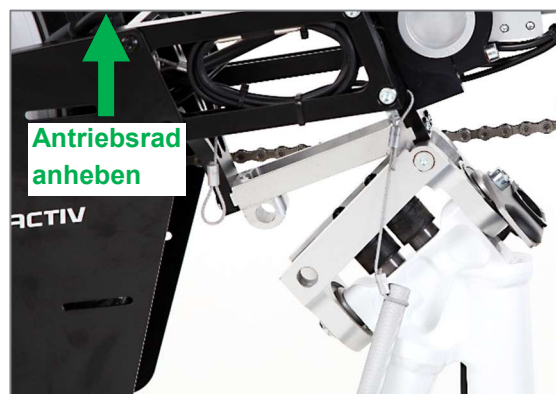
Abbildung 70: Anheben des Antriebsrads
