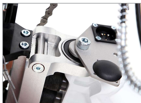
Abbildung 61: Einhängemaß der Antriebseinheit rutscht unter die Einhängewelle am Chassis
