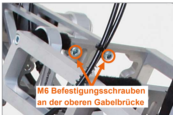
Abbildung 5: M6 Befestigungsschrauben an der oberen Gabelbrücke
