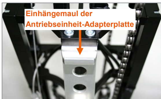
Abbildung 59: Einhängemaß der Antriebseinheit-Adapterplatte
