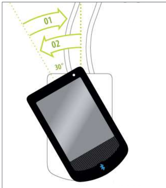
Abbildung 29: Anbringung und Abnahme des Displays
