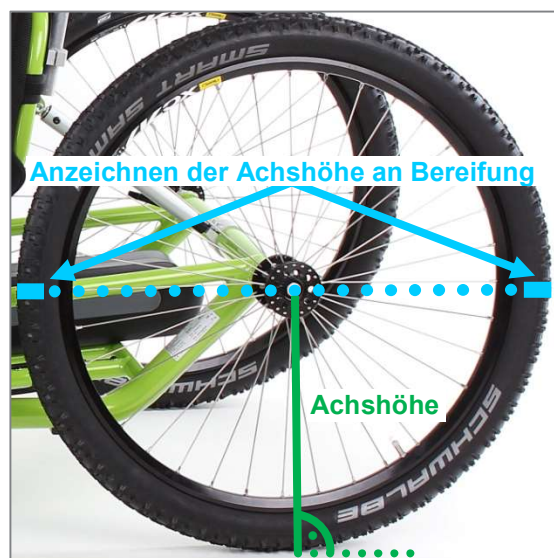
Abbildung 50: Anzeichnen der Achshöhe vorne und hinten auf beiden Bereifungen der Laufräder
