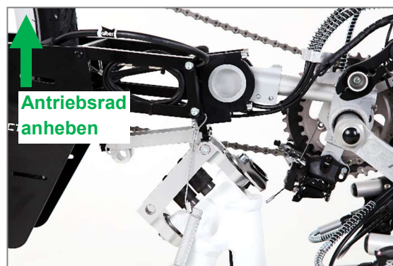
Abbildung 60: Anheben des Antriebsrads
