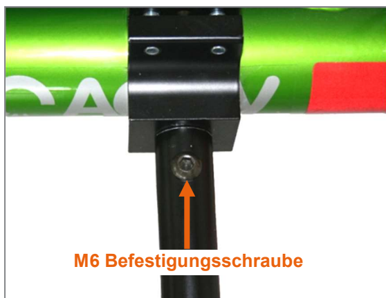
Abbildung 46: M6 Befestigungsschrauben an den Klemmschellen am Achsrohr
