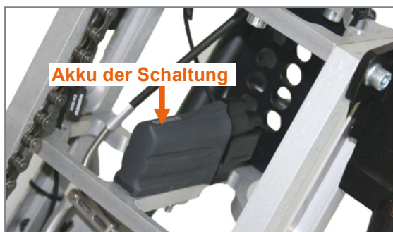
Abbildung 15: Akku der elektronischen Schaltung Alfine Di2
