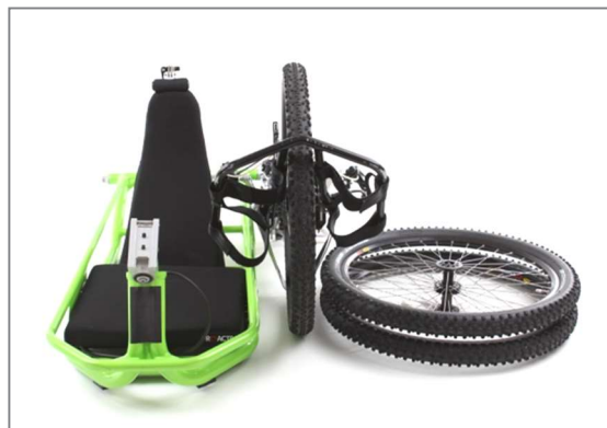
Abbildung 71: Packmaß: Chassis und Antriebseinheit getrennt und Laufräder abgenommen
