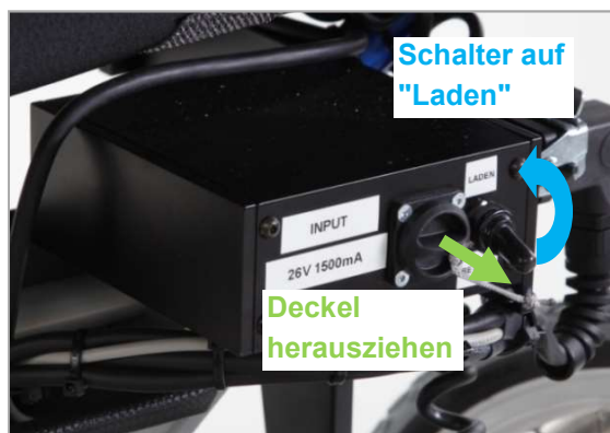
Abbildung 158: Vorbereitung für das Laden an der Rollstuhlrückseite
