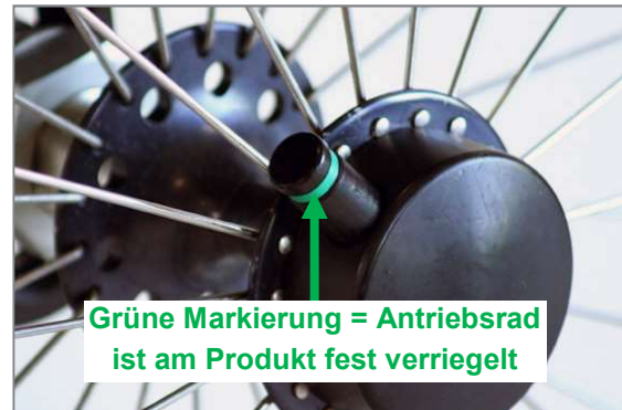
Abbildung 53: Tetra-Clip mit verriegelter Steckachse
