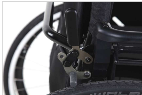
Abbildung 128: Kniehebelbremse hinten montiert (Ansicht von der Seite)
