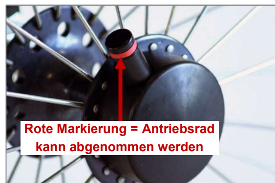
Abbildung 54: Tetra-Clip mit geöffneter Steckachse, Antriebsrad kann abgenommen werden
