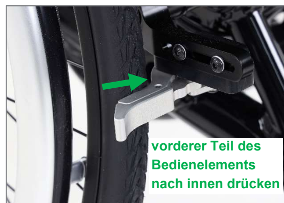
Abbildung 134: Integralbremse geschlossen; Öffnen erfolgt durch Drücken des Bedienelements zur Rollstuhlmitte
