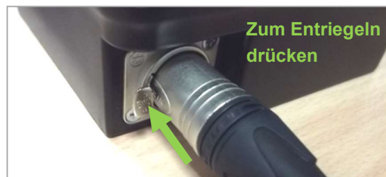
Abbildung 157: Entriegeln des Ladegerät-Steckers
