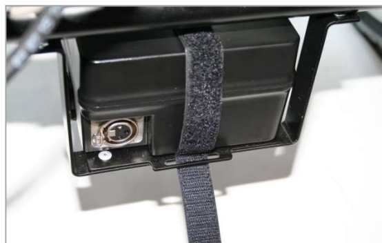
Abbildung 160: Klettband lösen, Schritt 1
