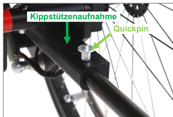
Abbildung 115: Kippstütze mit Quickpin (Ansicht von hinten)
