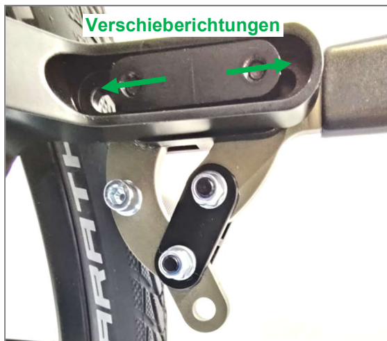
Abbildung 121: Verschieberichtungen (LIFT activ; Ansicht von Rollstuhlinnenseite)
