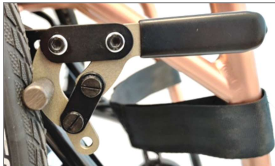
Abbildung 118: Kniehebelbremssystem mit Bremshebel Standard
