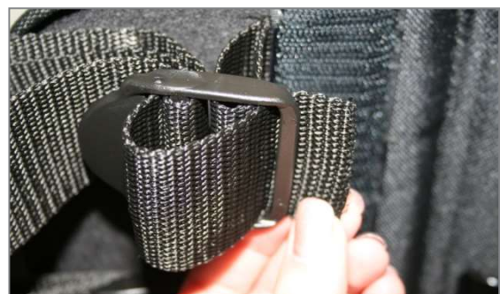
Abbildung 33: Schritt 8: Einfädeln des Gurtes
