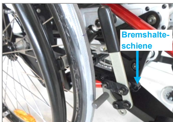
Abbildung 123: Kniehebelbremse (tief montiert), Bremshebel lang; LIFT solid
