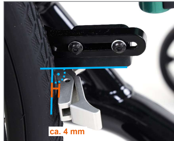
Abbildung 136: Bremselement nach richtiger Positionierung der Integralbremse
