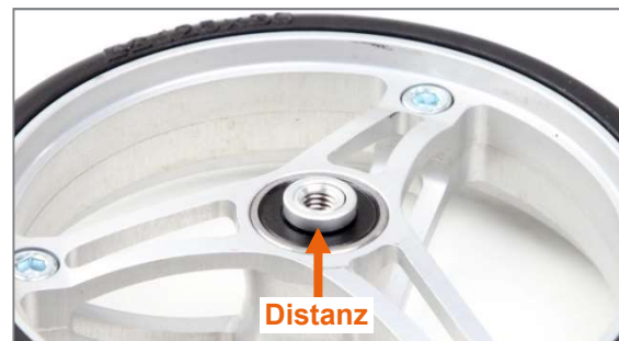
Abbildung 67: Distanz am Lenkrad
