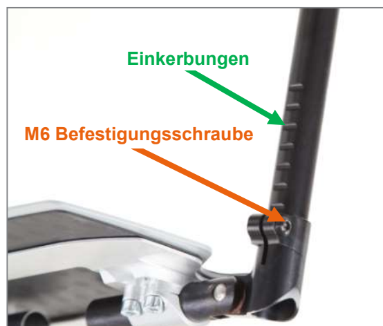
Abbildung 94: Einkerbungen und M6 Befestigungsschraube zur Unterschenkelängen-Einstellung (Ansicht von hinten)
