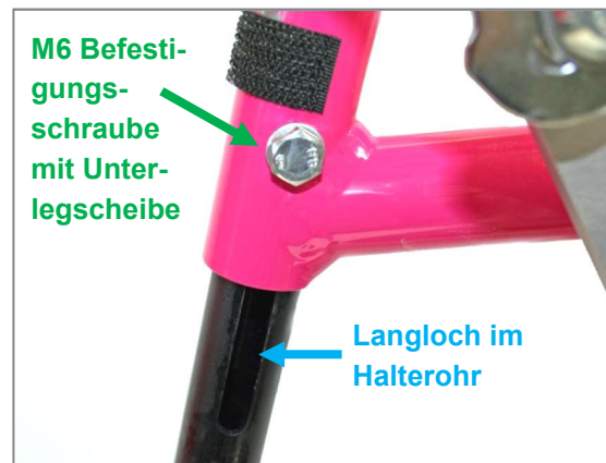
Abbildung 100: M6 Befestigungsschraube mit Unterlegscheibe und Langloch im Fußstützen-Halterrohr zur Einstellung der Unterschenkellänge
