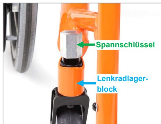
Abbildung 76: Lösen der Mutter der Lenkradgabeldrehachse mit dem Spannschlüssel
