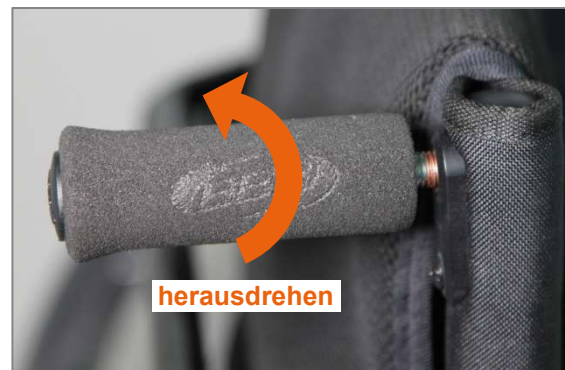
Abbildung 140: Schiebegriff horizontal aus dem Rückenrohr herausdrehen
