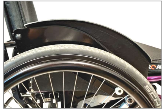
Abbildung 44: Kleiderschutz am Produkt angebracht (Ansicht mit Antriebsrad)
