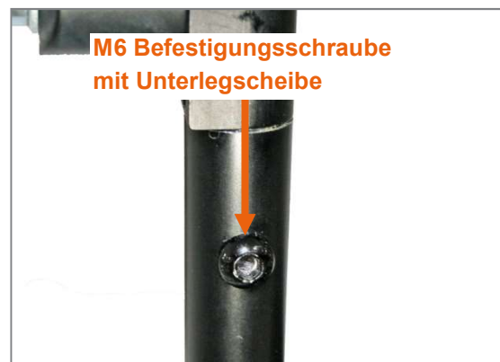
Abbildung 90: M6 Befestigungsschraube mit Unterlegscheibe zur Einstellung der Unterschenkelänge
