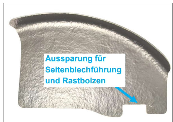
Abbildung 46: Kleiderschutz vom Produkt abgenommen
