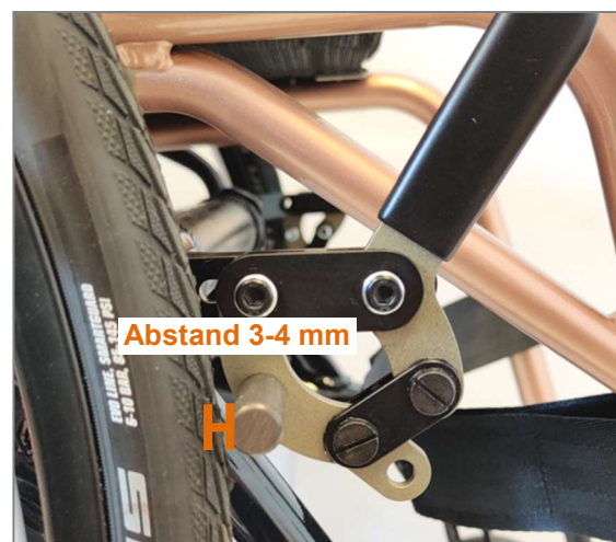
Abbildung 125: Abstand zwischen Bremsbolzen und Bereifung von ca. 3 bis maximal 4 mm bei geöffneter Bremse (vorne montiert)
