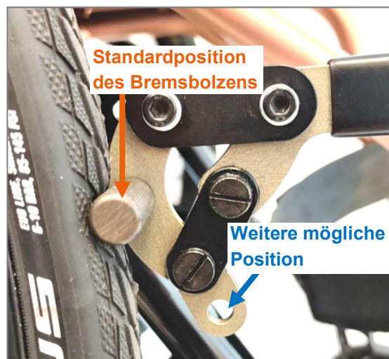
Abbildung 127: Positionen des Bremsbolzens (vorne montiert)
