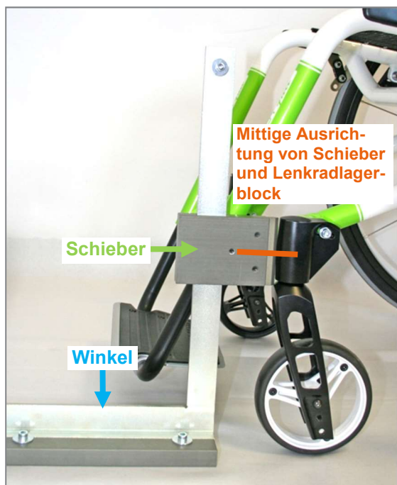
Abbildung 79: Überprüfung der Einstellung der Lenkradgabeldehachsen
