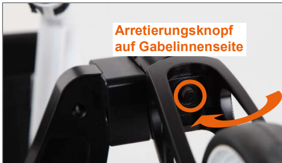
Abbildung 78: Lenkradgabel mit Steckachse und Arretierungsknopf
