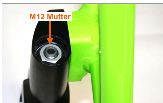
Abbildung 75: Alu-Kappe abgenommen und M12 Mutter sichtbar
