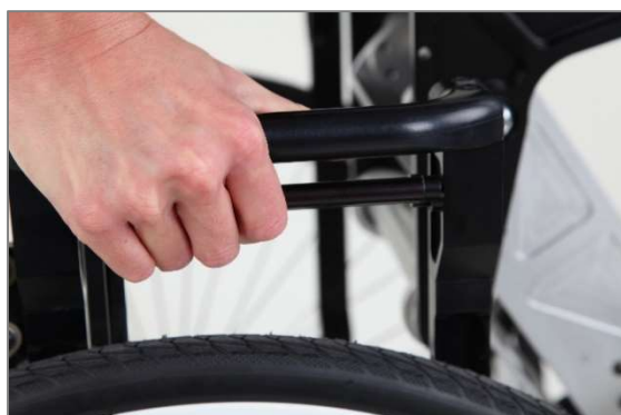
Abbildung 150: Betätigter Auslösemechanismus mechanisch
