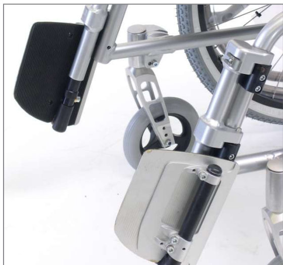
Abbildung 102: Beide Fußstützenteile hochgeklappt und nach außen gedreht
