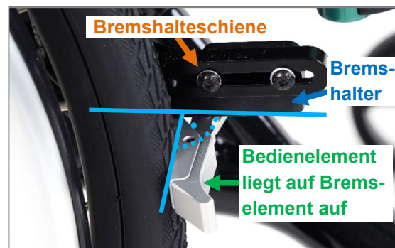
Abbildung 133: Integralbremse geschlossen; Bremsselement senkrecht zum Bremshalter
