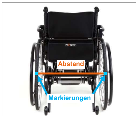
Abbildung 56: Abstand zwischen den Markierungen der Reifen (auf Achshöhe), (Ansicht von hinten; LIFT solid)
