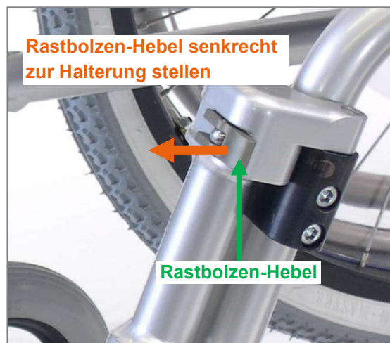
Abbildung 103: Rastbolzen-Hebel zur Abnahme der Swing away Fußstütze senkrecht stellen
