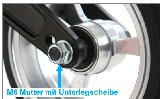
Abbildung 69: M6 Mutter der Lenkradachse (Ansicht von Produktinnenseite)
