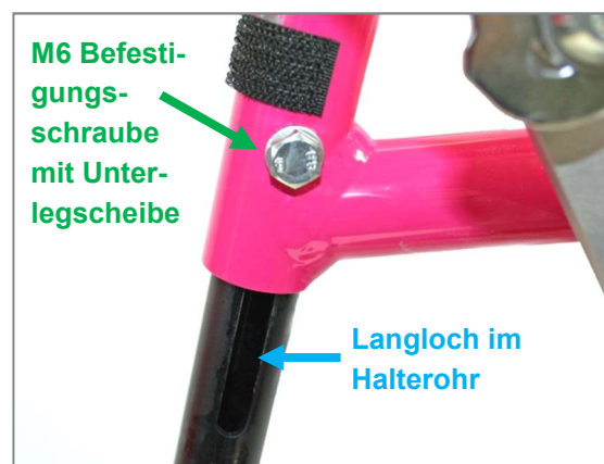
Abbildung 97: M6 Befestigungsschraube mit Unterlegscheibe und Langloch im Fußstützen-Halterohr zur Einstellung der Unterschenkelänge
