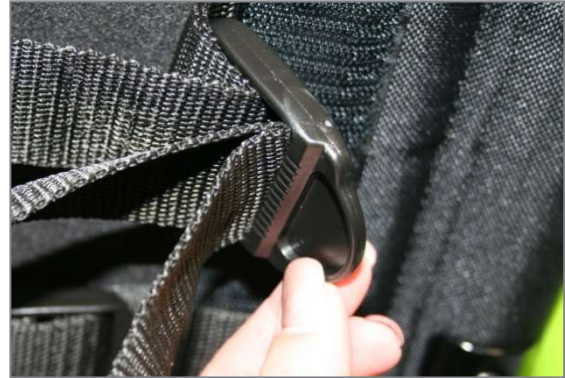
Abbildung 30: Schritt 5: Zurückführen des Gurtes durch die Spannöse um die geforderte "doppelte Durchführung" zu erhalten
