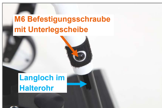
Abbildung 85: M6 Befestigungsschraube mit Unterlegscheibe und Langloch im Fußstützen-Halterohr zur Einstellung der Unterschenkelhöhe
