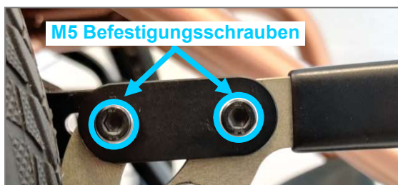
Abbildung 122: M5 Befestigungsschrauben an der Bremshalteschiene (vorne montiert); LIFT activ
