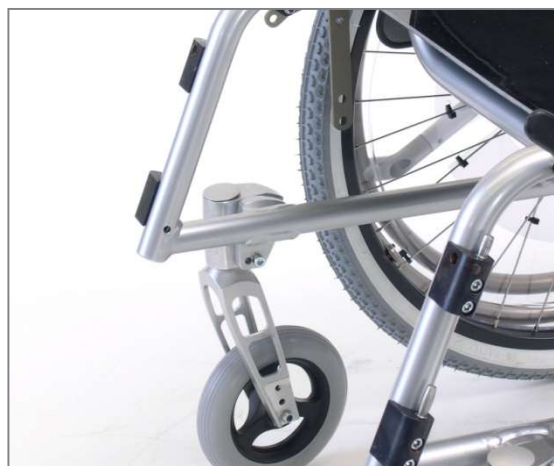
Abbildung 104: Swing away Fußstütze abgenommen
