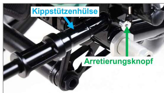
Abbildung 108: Quickpin mit Arretierungsknopf
