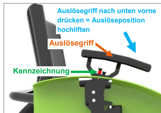
Abbildung 147: Auslösegriff in Auslöseposition hochheben
