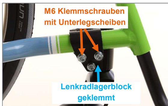
Abbildung 85: M6 Klemmschrauben beim geklemmten Lenkradlagerblock
