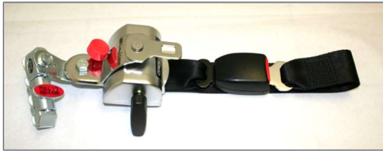
Abbildung 139: Retraktor hinten „Semi-Automatik“ mit Handrad, Gurtschloss und Schlosszunge
