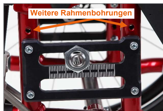
Abbildung 10: Rahmenbohrungen (Ansicht von Produktaußenseite, Antriehsrad abgenommen)
