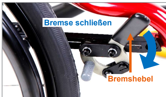
Abbildung 112: Bremse geöffnet; Schließen erfolgt durch nach vorne-unten Drücken des Bremshebels
