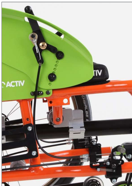
Abbildung 122: Kniehebelbremssystem mit Bremsbedienung oben im Kleiderschutz integriert
