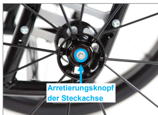
Abbildung 54: Arretierungsknopf der Steckachse in der Mitte der Radachse
