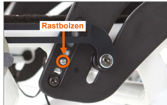
Abbildung 21: Rastbolzen greift in das Arretierungsloch im Seitenteil (Ansicht von Produktaußenseite, ohne Kleiderschutz)
