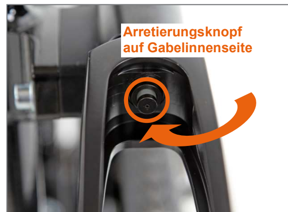
Abbildung 80: Lenkradgabel mit Steckachse und Arretierungsknopf
