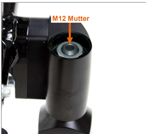
Abbildung 79: Alu-Kappe abgenommen und M12 Mutter sichtbar
