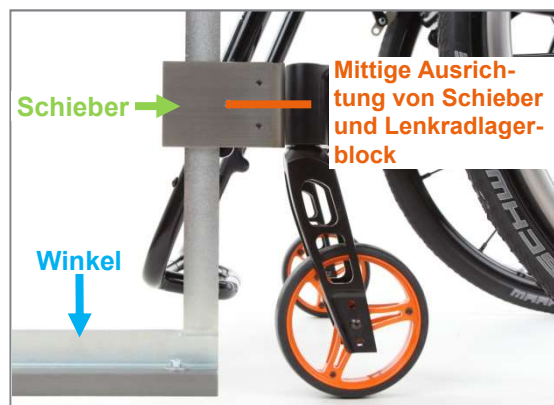
Abbildung 81: Überprüfung der Einstellung der Lenkradgabel-drehachsen
