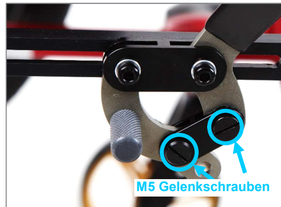
Abbildung 116: M5 Gelenkschrauben zur Einstellung der Betätigungskraft des Bremshebels
