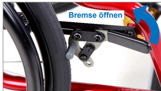
Abbildung 113: Bremse geschlossen; Öffnen erfolgt durch nach hinten-oben Ziehen des Bremshebels
