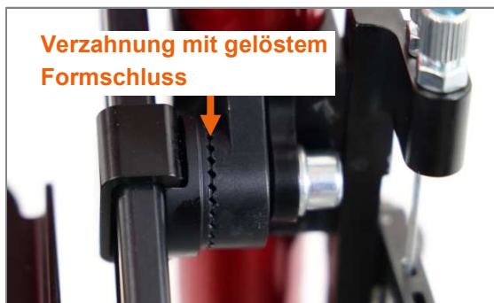
Abbildung 104: Verzahnung am Fußbügelspanner, gelöster Formschluss
