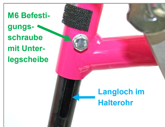
Abbildung 95: M6 Befestigungsschraube mit Unterlegscheibe und Langloch im Fußstützen-Halterohr zur Einstellung der Unterschenkelänge
