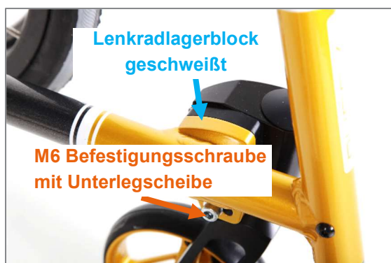
Abbildung 83: M6 Befestigungsschraube an der Rahmeninnenseite mit Unterlegscheibe
