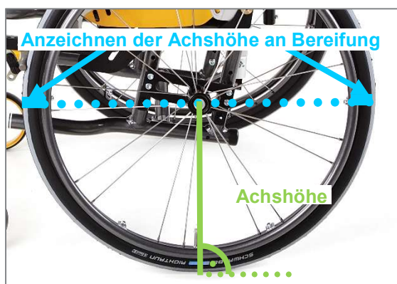
Abbildung 60: Anzeichnen der Achshöhe vorne und hinten auf beiden Reifen
