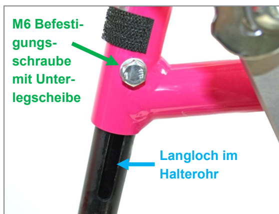
Abbildung 101: M6 Befestigungsschraube mit Unterlegscheibe und Langloch im Fußstützen-Halterohr zur Einstellung der Unterschenkelänge
