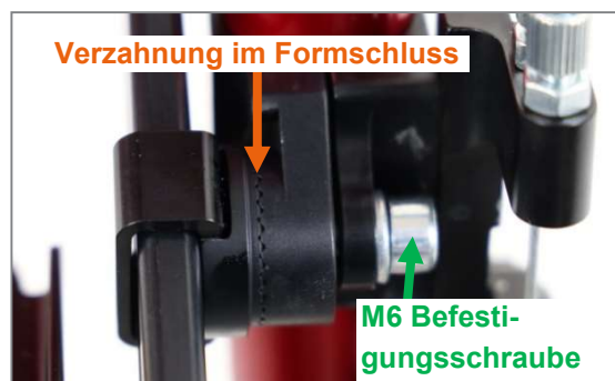
Abbildung 103: Verzahnung am Fußbügelspanner, im Formschluss
