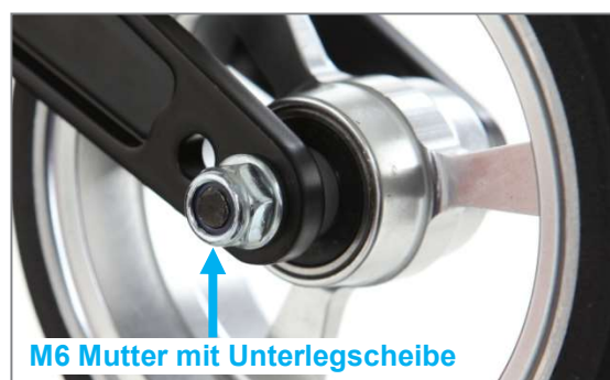
Abbildung 73: M6 Mutter der Lenkradachse (Ansicht von Produktinnenseite)
