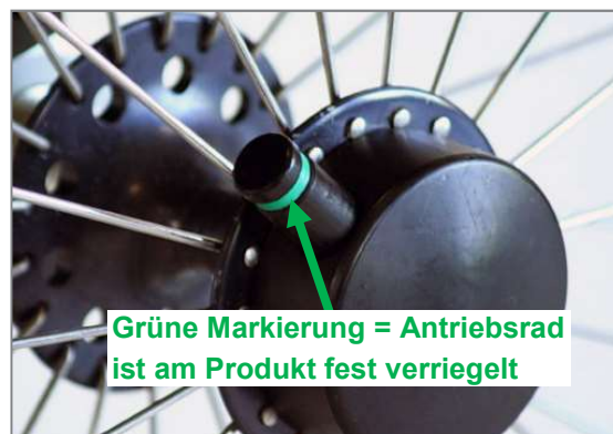
Abbildung 57: Tetra-Clip mit verriegelter Steckachse
