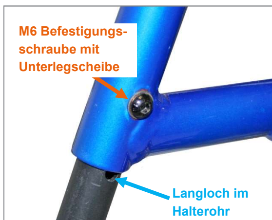
Abbildung 88: M6 Befestigungsschraube mit Unterlegscheibe und Langloch im Fußstützen-Halterohr zur Einstellung der Unterschenkelhöhe
