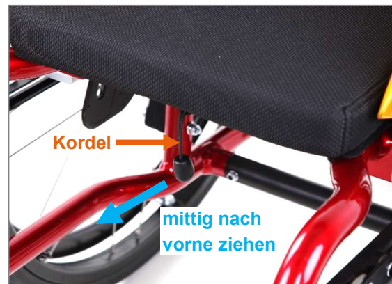
Abbildung 22: Kordel für die Betätigung der Rastbolzen und damit zur Verstellung des Rückenlehnenwinkels
